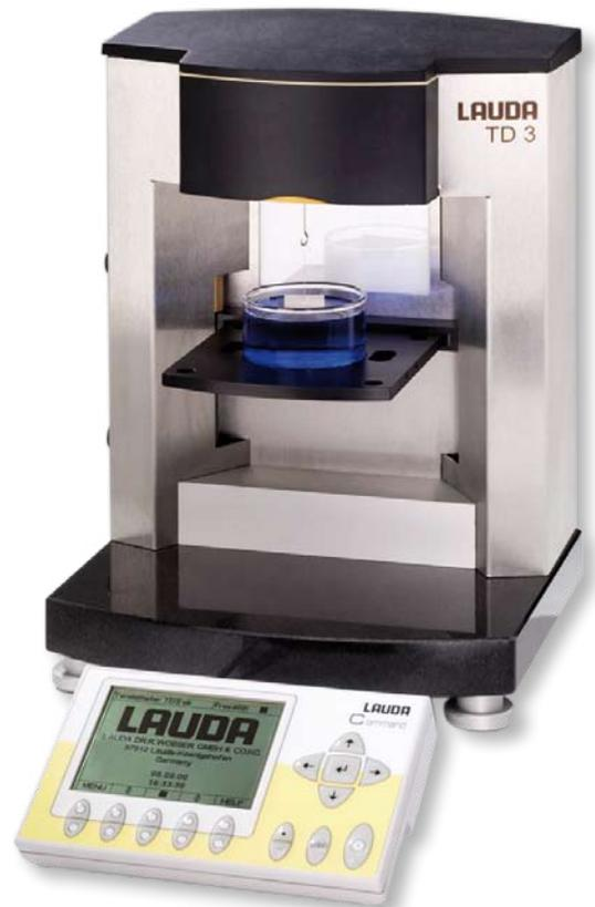
Tensiómetro TD 3 con unidad de control remoto Command
