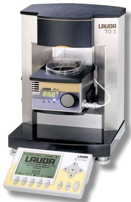
Tensiómetro TD 3 con PTT y unidad de control remoto Command
